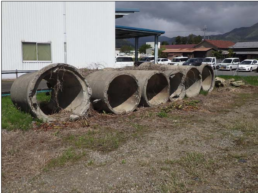
室山地区 ヒューム管
